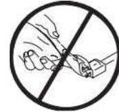
No utilice el equipo si el cable eléctrico tiene una clavija de conexión a tierra dañada. No modifique la clavija suministrada; si no encaja en la toma eléctrica, pida a un electricista cualificado que instale una toma de corriente adecuada.
